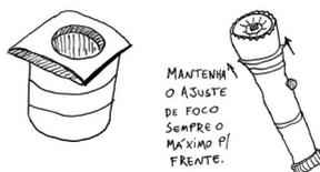
18. Encaixe a base do suporte de slides na frente da lanterna e a lanterna na abraçadeira do chassi. Deixe sempre o foco da lanterna sempre puxado o máximo possível para a frente.
