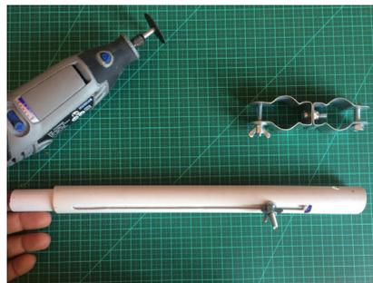
8. Encaixe o parafuso (A) pelo furo alargado, atravessando os dois canos e saindo pela canaleta do cano maior (3/4"). Quando a cabeça do parafuso (A) travar no interior do cano menor (1/2"), afixe a arruela e a porca-borboleta.
